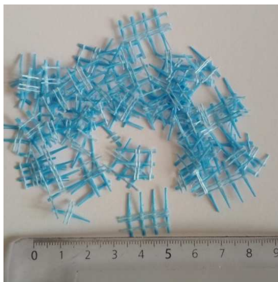
Рисунок 1. – Отходы производства щелочестойкой стеклосетки ССШ-160(100)-1800/1800
