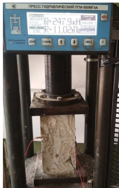
Рисунок 2. – Испытание бетонного образца с установленными в него глубинными датчиками
