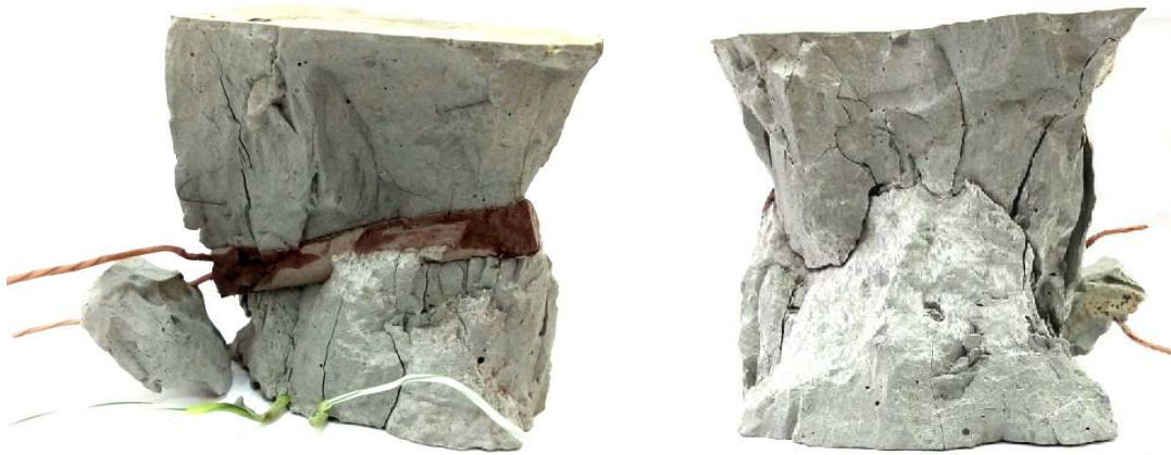
Рисунок 6. – Характер разрушения цементного куба
