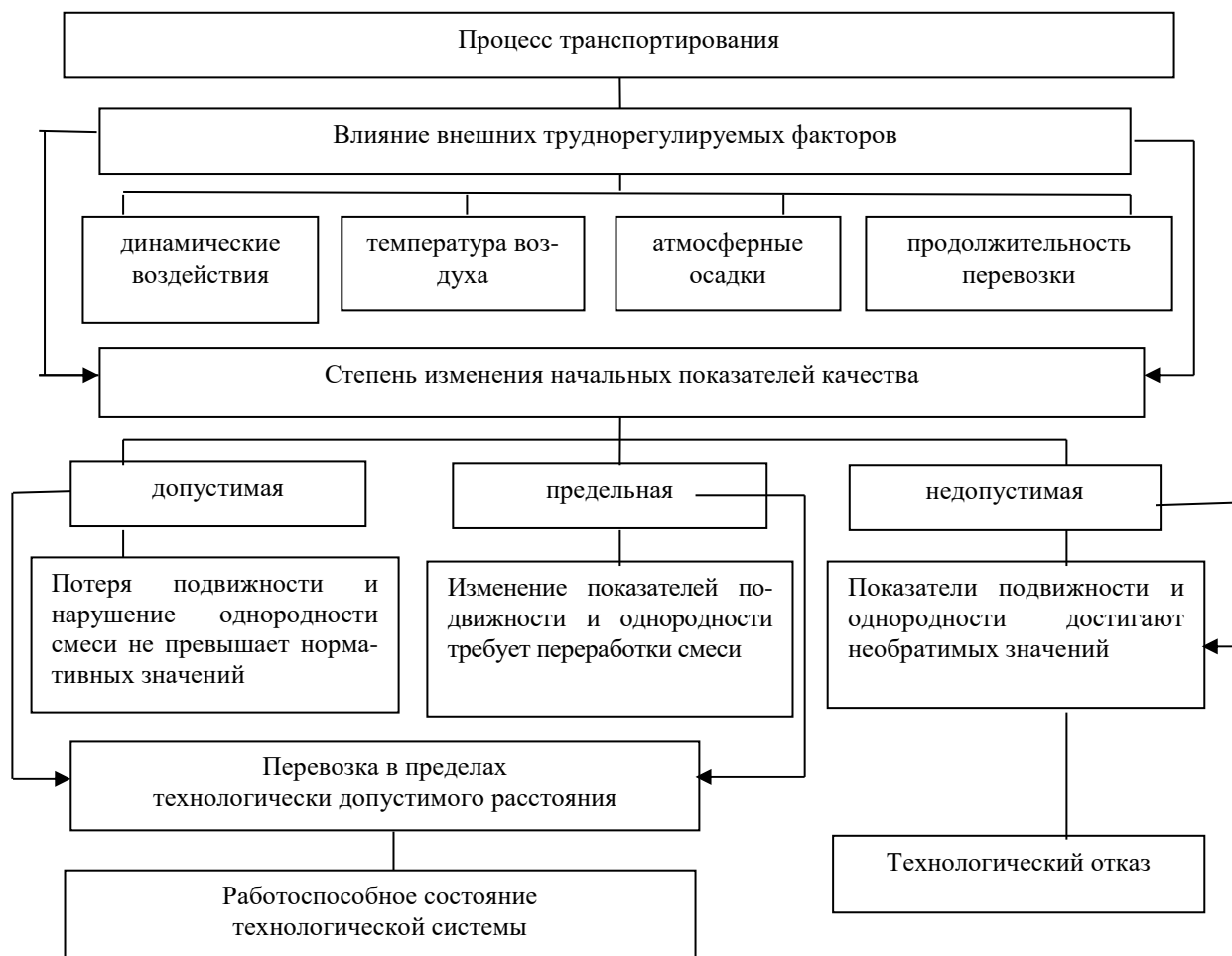
Рисунок. – Влияние внешних факторов на качество бетонной смеси при ее транспортировании
