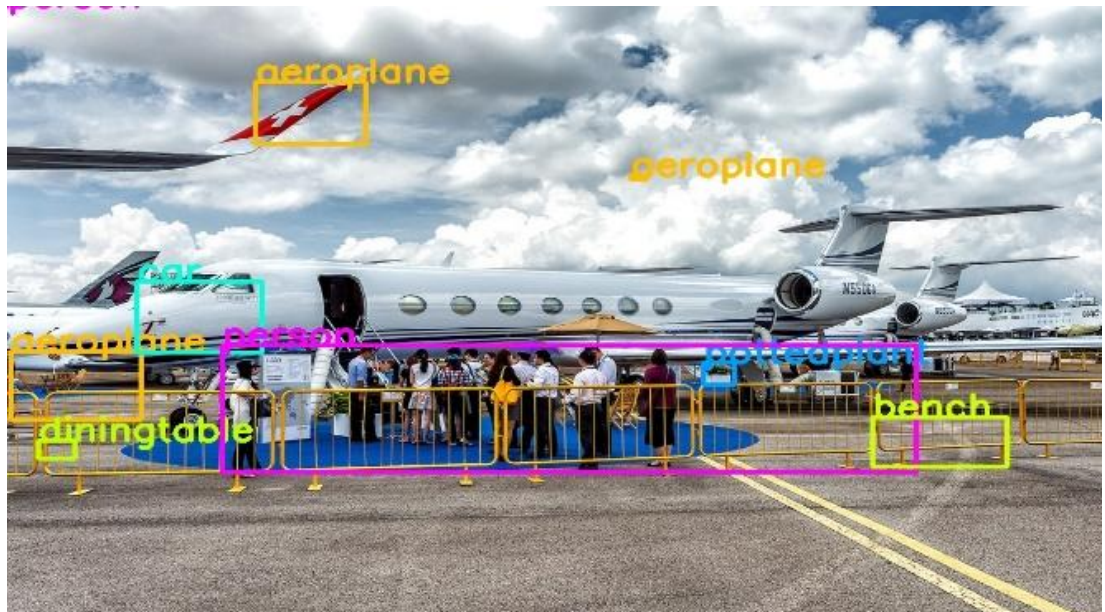
Рисунок 25 - Пример ложной классификации фрагмента объекта
