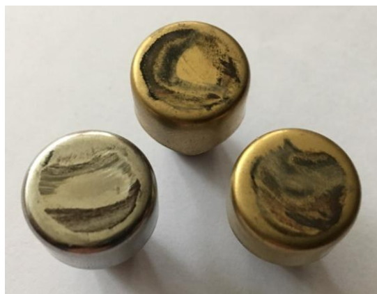
Рисунок 3.6 – Внешний вид образцов после испытания на машине трения при следующих режимах: усилие прижима – 40Н, скорость – 200мин -1 , время – 560сек
