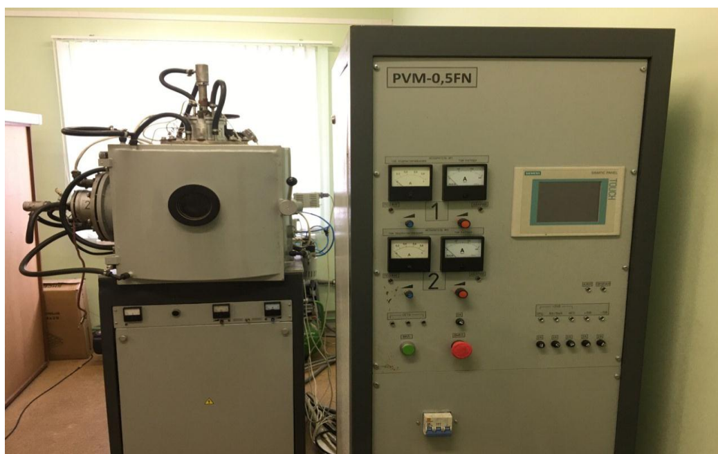
Рисунок 7.1 – Внешний вид вакуумной установки PVM-0,5 FN
