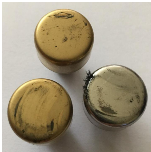
Рисунок 3.5 – Внешний вид образцов после испытания на машине трения при следующих режимах: усилие прижима – 20Н, скорость – 200мин -1 , время – 560сек
