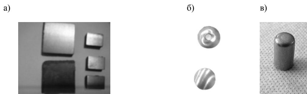
Рисунок 2.1 – Внешний вид образцов плоских поверхностей с газотермическим и ионно-плазменным покрытием (а), сферических (б) и цилиндрических (в) поверхностей с ионно-плазменным покрытием
