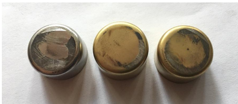
Рисунок 3.11 – Внешний вид образцов после испытания на машине трения при следующих режимах: усилие прижима – 300Н, скорость – 200мин -1 , время – 560сек
