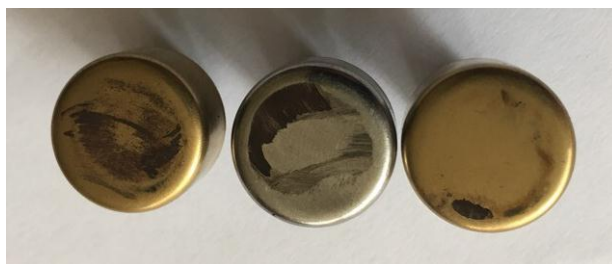
Рисунок 3.8 – Внешний вид образцов после испытания на машине трения при следующих режимах: усилие прижима – 70Н, скорость – 200мин -1 , время – 560сек
