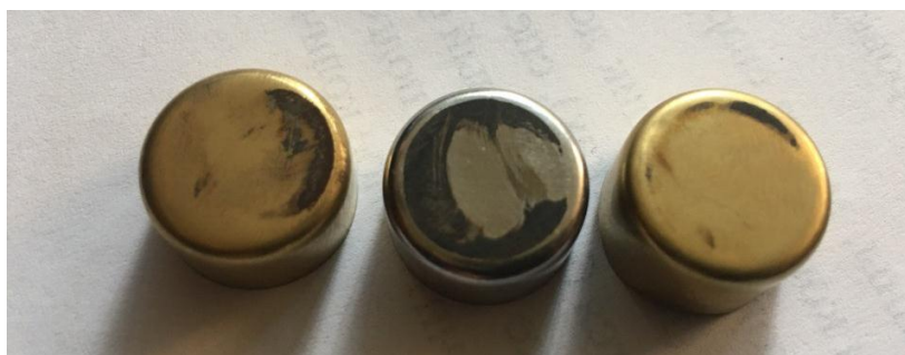
Рисунок 3.10 – Внешний вид образцов после испытания на машине трения при следующих режимах: усилие прижима – 150Н, скорость – 200мин -1 , время – 560сек
