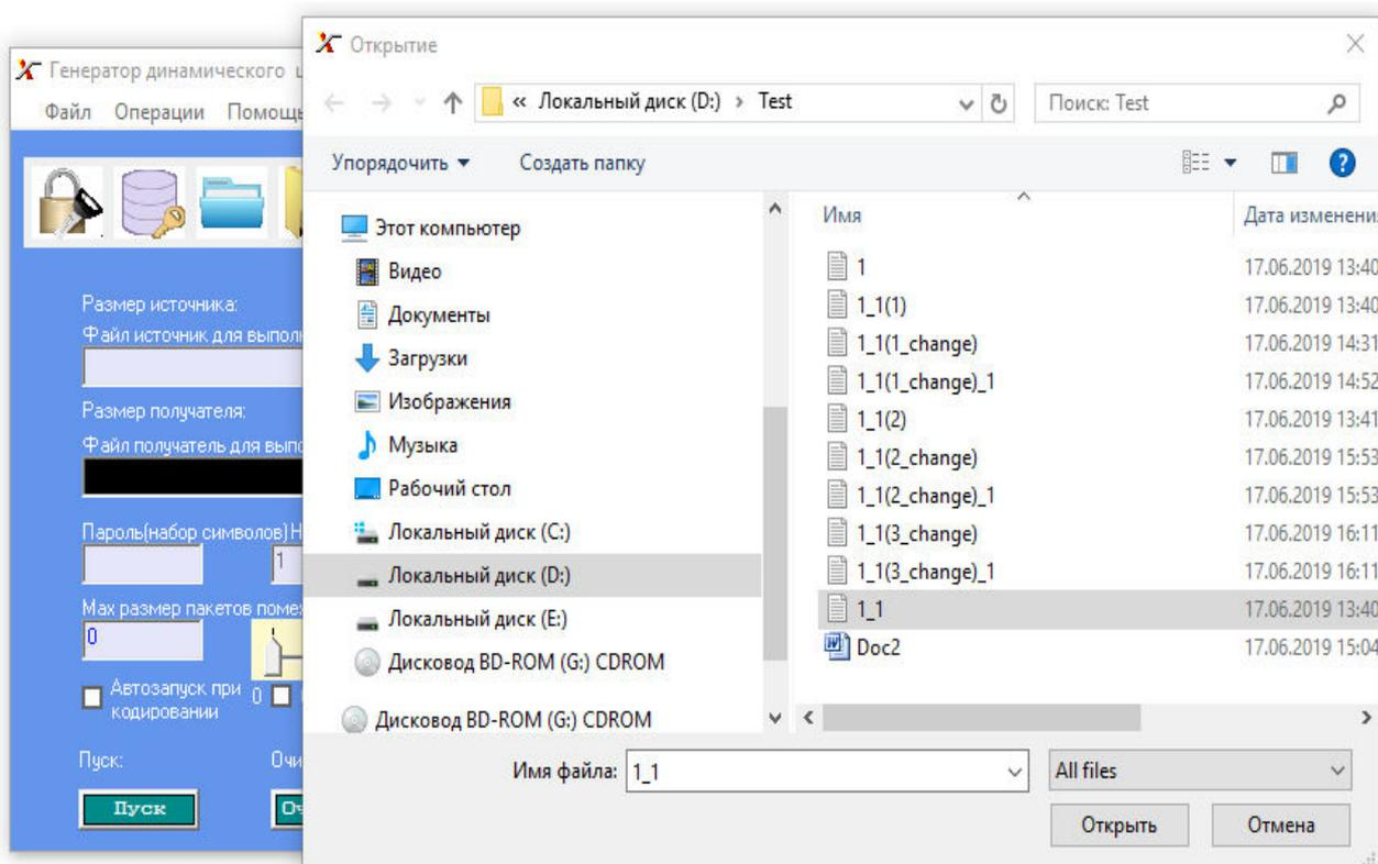
Пример шифрования и дешифрования. На рисунке представлен шифр записанный в файл 1\_1.txt. Начальная точка генератора последовательностей псевдослучайных чисел меняется при каждом шифровании, в результате чего коды одного и того же сообщения отличаются, но декодируются они одинаково.
