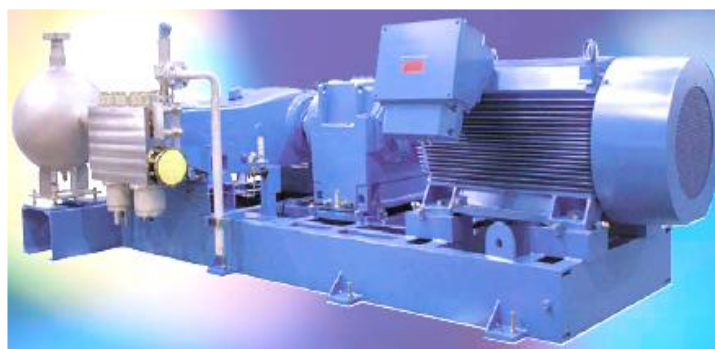
Рис. 1. Агрегат высокого давления с приводным электродвигателем ( P = 3200 бар и Q = 38,5 л/мин)
