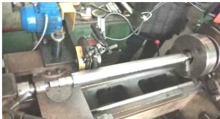
Рисунок 5. – Фотоснимок процесса формирования покрытия «хром + УДАГ» методом ЭДПГИ на рабочей поверхности штока гидроцилиндра
