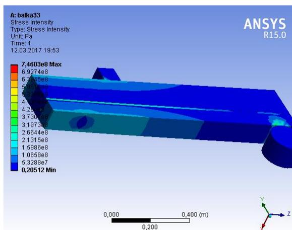
Рис. 1а. Скрытая поперечная трещина в поле напряжений балки с нагрузкой  $F = 600000 \text{ Н}$  .
