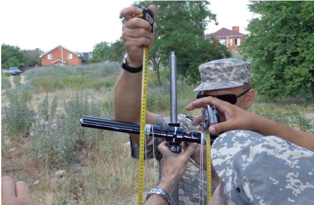
Фото № 9. – Окончательная выверка положения ствола визира
