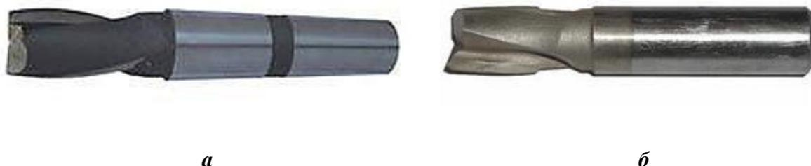
*a* – с коническим хвостовиком; *б* – с цилиндрическим хвостовиком
