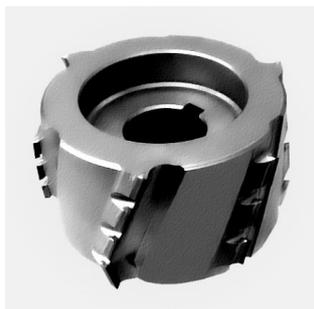
**Рисунок 7. – Алмазная фреза «MICROTECH»**
