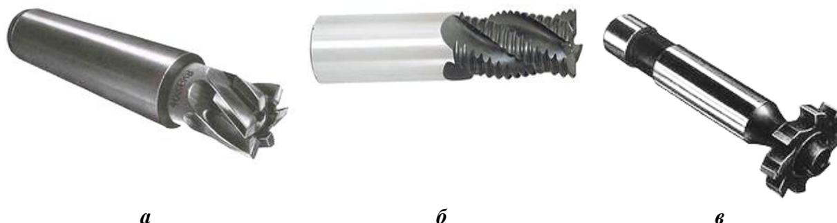
*а* – хвостовая; *б* – обдирочная хвостовая; *в* – шпоночная дисковая
