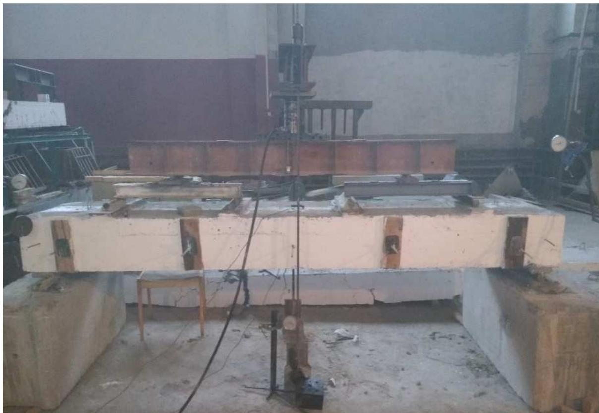
Рисунок 5. – Стенд для испытания образцов
