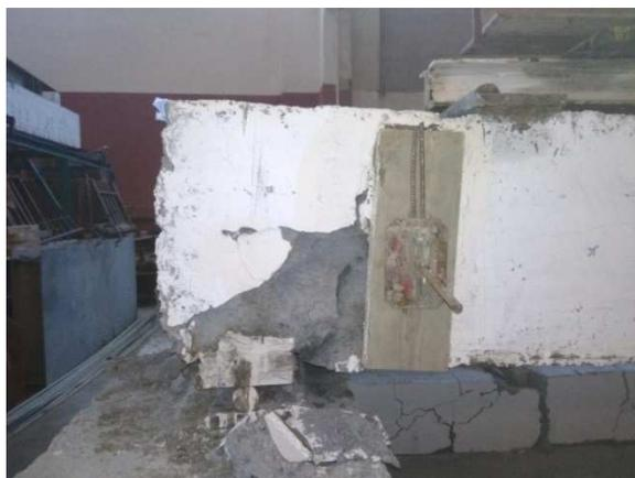
Рисунок 6. – Разрушение на опоре: а – плита I; б – плита II
