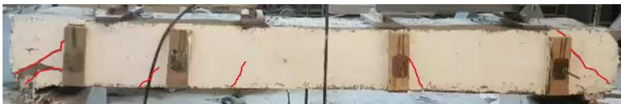
Рисунок 7. – Схема трещинообразования: а – плита I; б – плита II
