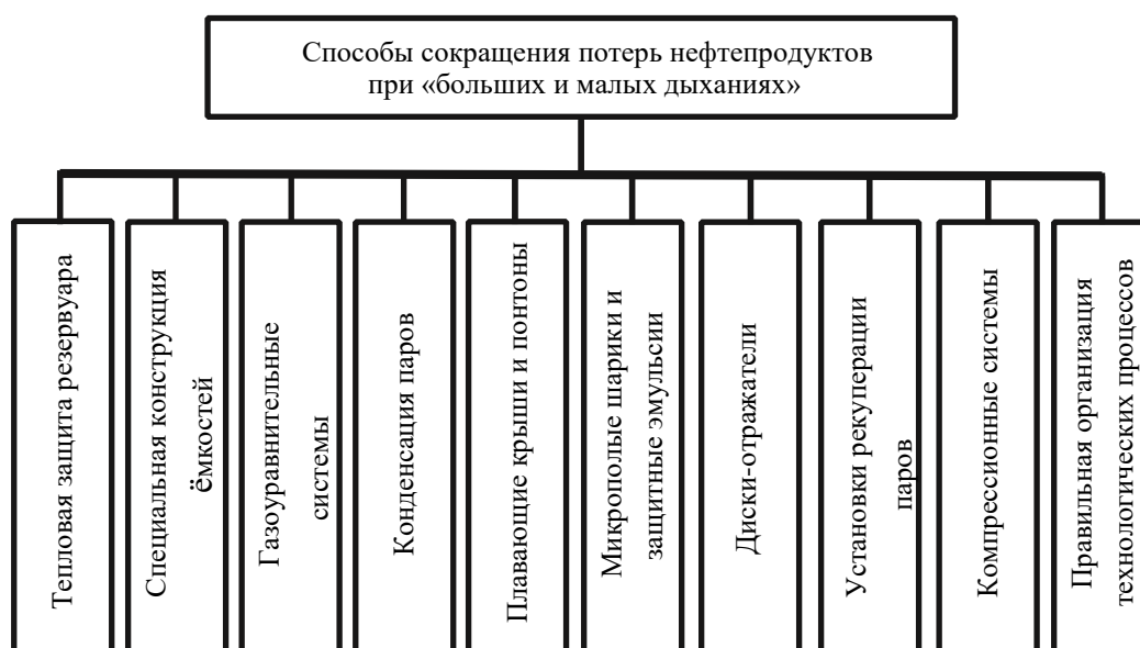
Рисунок 2.1 – Способы сокращения потерь от испарения
