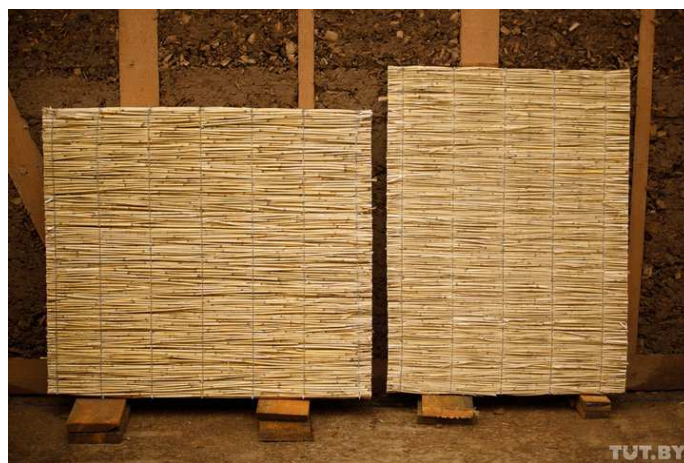
Рисунок 2. – Тростниковая плита утеплителя
