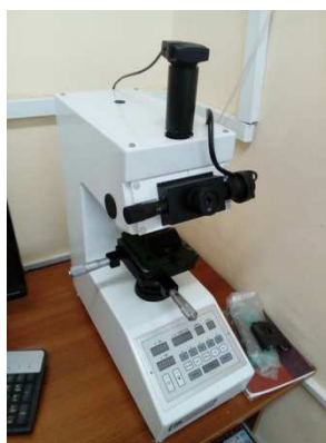
Рисунок 7. – Твердомер BUEHLER Model No 1105D
