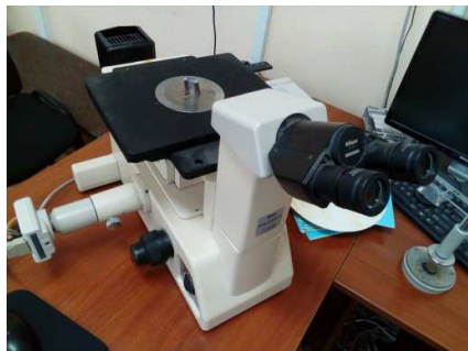
Рисунок 5. – Инвертированный металлографический микроскоп Nikon "Epihot200"
