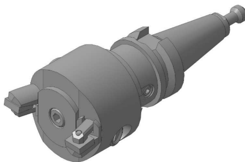
Рисунок 4. – 3D модель конструкции зенкера
