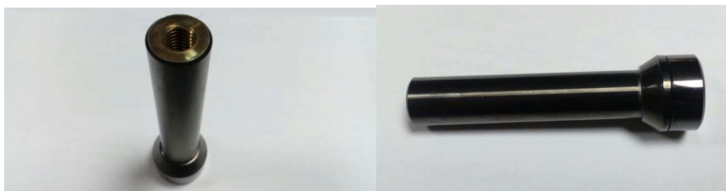
Рисунок 1. – Внешний вид ударной головки
