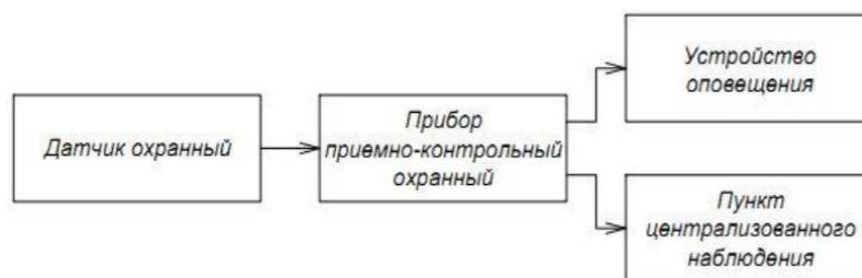
Рисунок. – Структурная схема охранной сигнализации
