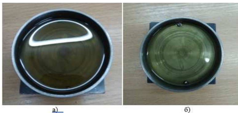
Рисунок 2. – Цвет масла: а – после первого этапа трения ИЧХ18 (0-6500м) б – после второго этапа (6500–13000 м)
