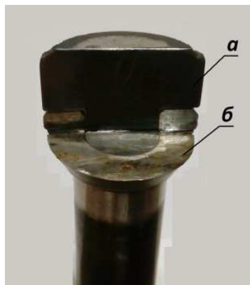
Рисунок 4. – Разрез изношенной ударной головки, бывшей в эксплуатации: а – наконечник; б – корпус
