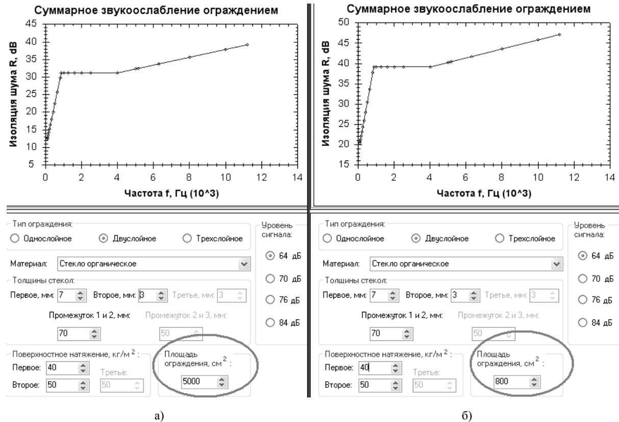
Рис. 5. Звукоослабление с учетом площади поверхности стекла: а – площадь ограждения 5000 см<sup>2</sup>; б – площадь ограждения 800 см<sup>2</sup>
