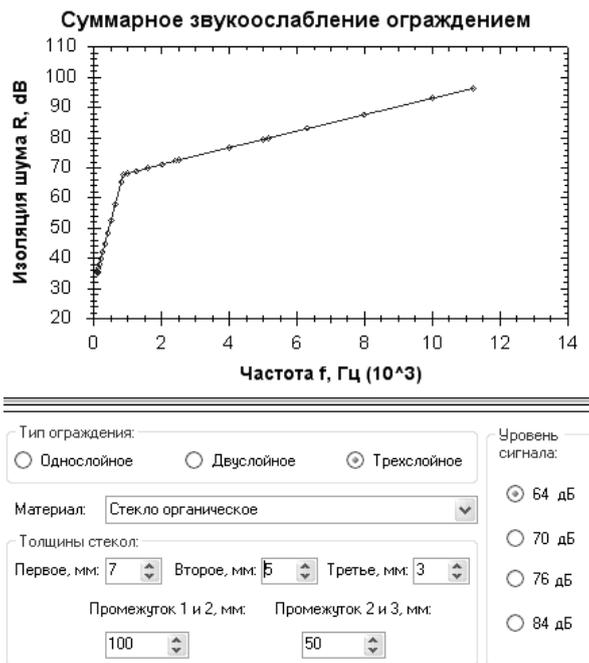
Рис. 4. Звукоослабление для трехслойного окна с различными толщинами стекол
