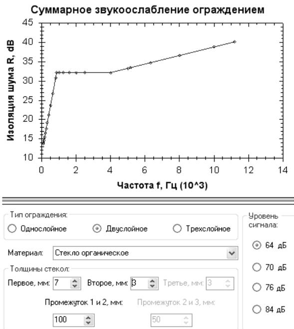
Рис. 3. Звукоослабление для двухслойного окна с различными толщинами стекол
