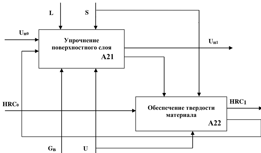
Рис. 9. Декомпозиция блока А2 (обеспечение физико-механических свойств)
