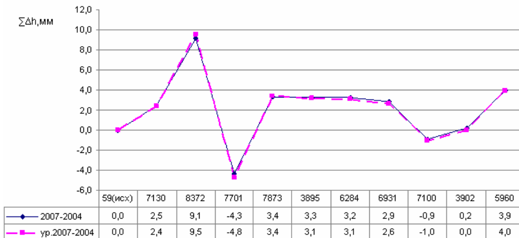
Рис. 3. Разности отметок реперов на Полоцком профиле, полученных из обработки 3-х циклов нивелирования – 2004, 2006 и 2007 гг.: а – ( H_{2006} - H_{2004} ); б – ( H_{2007} - H_{2004} )
