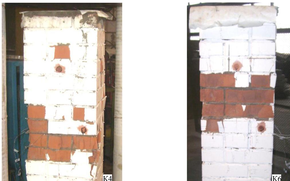
Рис. 4. Характер разрушения армированных образцов серий CII, CIII, CV и CVI
