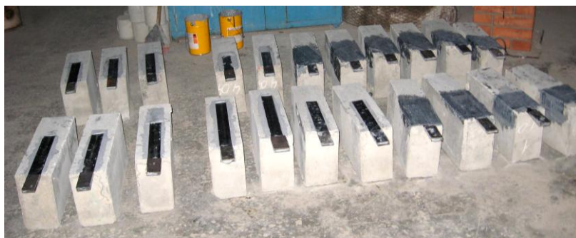
Рис. 2. Опытные образцы для проведения испытаний на сдвиг
