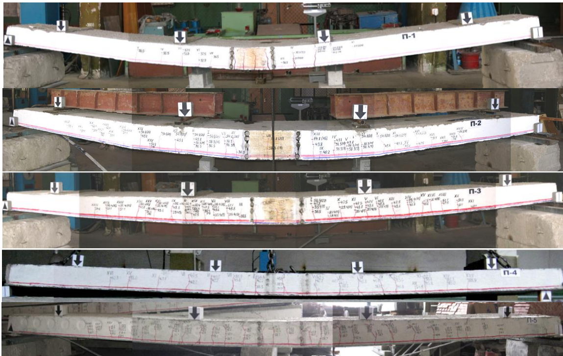
Рис. 8. Общий вид опытных плит П-1...П-5 после разрушения
