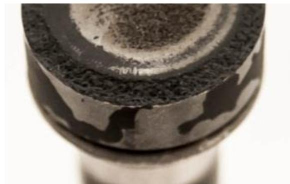
Рисунок 1. – Фаска изношенной гомогенизирующей головки
