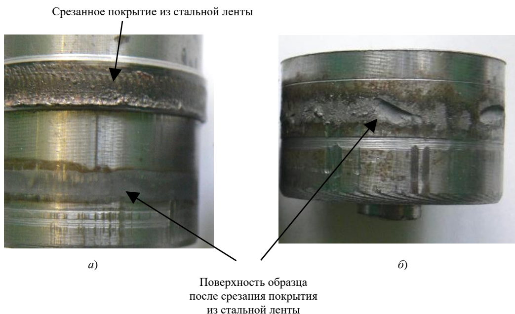
Рис. 7. Поверхность образцов после испытания на прочность сцепления покрытий из стальной ленты при режимах: а — I = 2 кА, t_{\text{умн}} = 0,06 с, t_{\text{паузы}} = 0,08 с; б — I = 3,9 кА, t_{\text{умн}} = 0,12 с, t_{\text{паузы}} = 0,2 с
