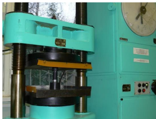
Рис. 4. Схема испытания и пресс для испытания прочности сцепления покрытия на срез: 1 – образец; 2 – покрытие; 3 – кольцо
