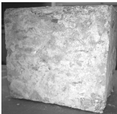
Рис. 9. Образец  $20 \times 20 \times 20$  см при оптимальной частоте и амплитуде горизонтальных колебаний
