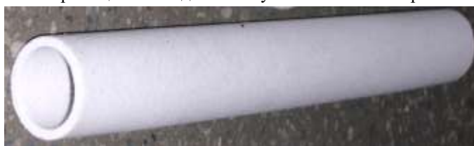
Рис. 2. Вид пористой трубы на основе кварца
