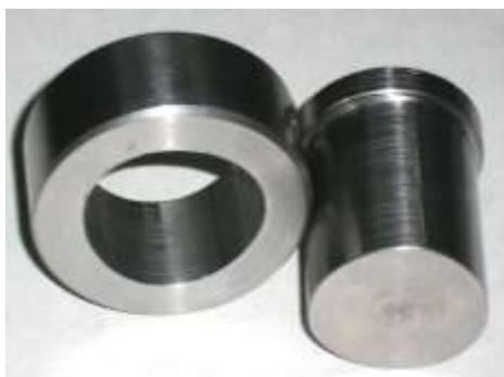
Рис. 5. Образцы деталей моментопередающего соединения с многогранным круговым срезанным контуром
