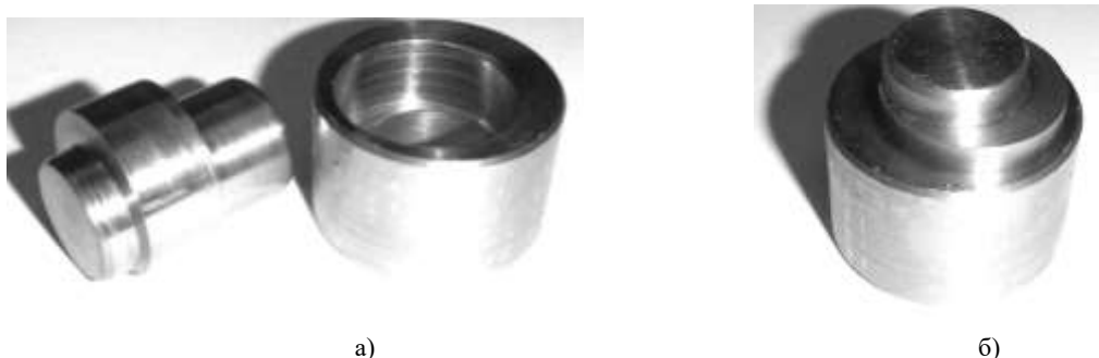
Рис. 3. Образец эксцентрикового моментопередающего соединения: а – детали соединения; б – соединение в сборе
