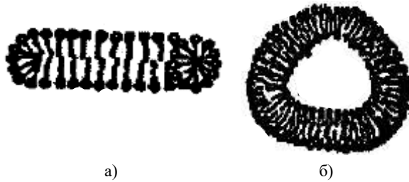
Рис. 6. Возможные микроструктуры мицелл асфальтенов в нефтяных остатках: а – «стержень»; б – везикула
