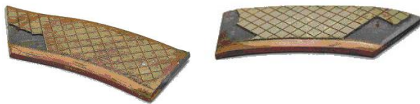
Рис. 1. Образцы бракованных фрикционных дисков
