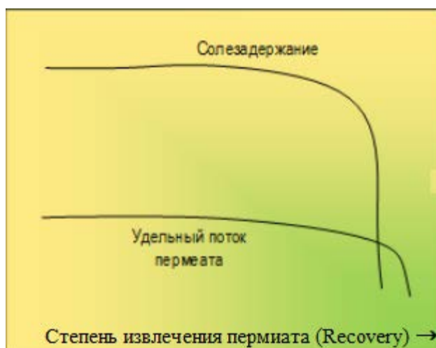
Рис. 2.12 - Влияние значения R (соотношение концентрата к фильтрату, выражается в процентах) - критерия на удельную производительность и солезадержание
