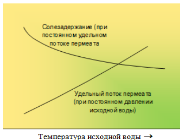
Рис.2.11 - Влияние температуры на удельную производительность и солезадержание
