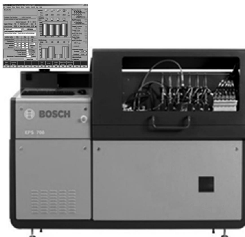
Рисунок 1.15 – Стенд Bosch EPS 708 для проверки компонентов топливной системы Common Rail
