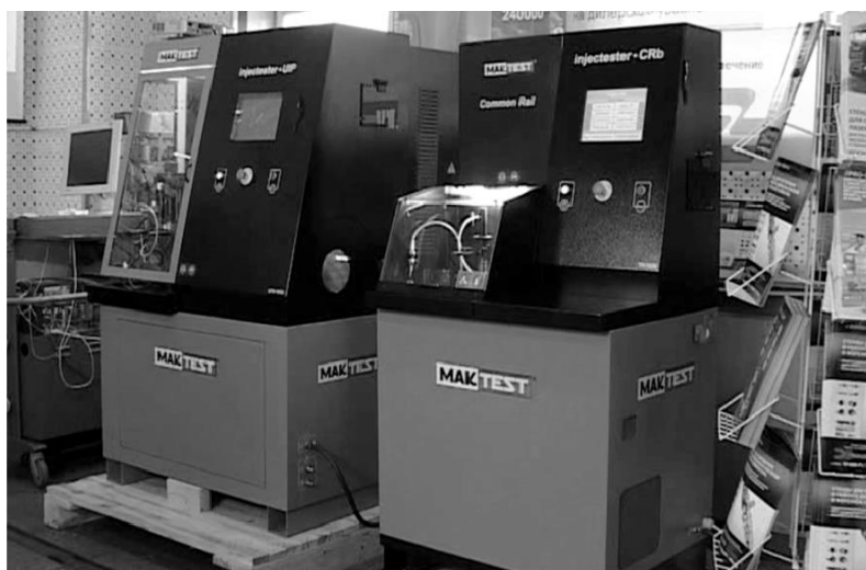
Рисунок 1.16 – Общий вид станда МАК TEST для проверки и ремонта форсунок
