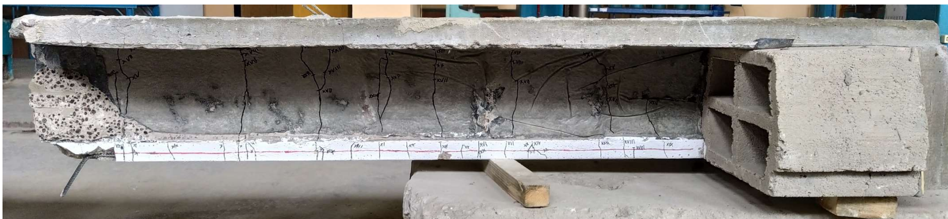
Рисунок 2.9 – Левая часть балки после разрушения (сторона Б)
