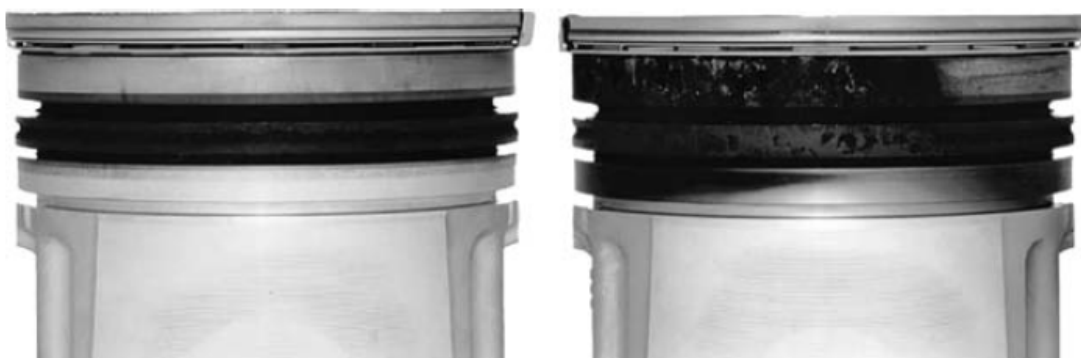
Рис. 1.7 Детергенты-дисперсанты обеспечивают чистоту поршней
