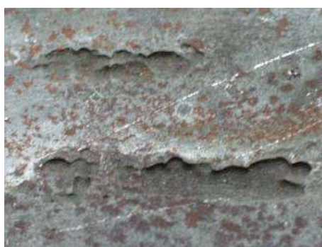
Рис. 5. Коррозионные повреждения внутренней поверхности нефтепроводов
