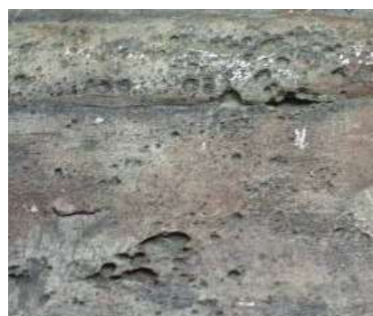
Рис. 5. Коррозионные повреждения внутренней поверхности нефтепроводов
