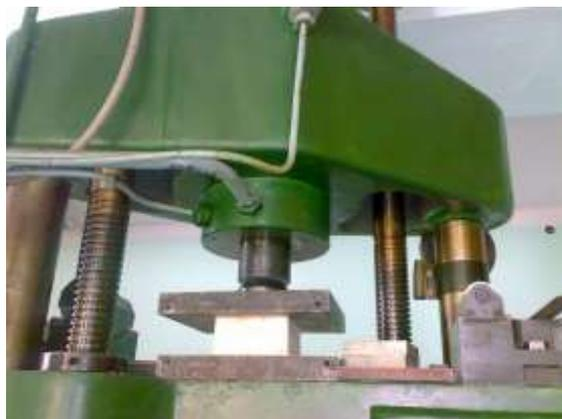
Рис. 2. Фрагмент испытания на универсальной испытательной машине ГМС-50, № 136 материала № 1
