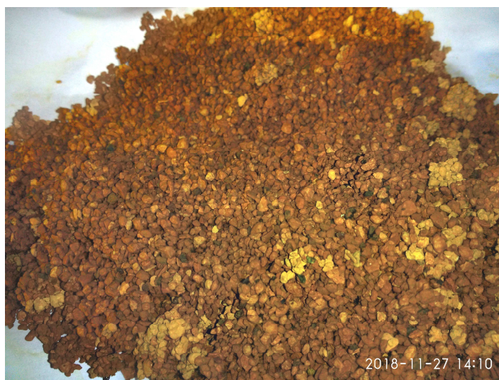
Рисунок 2. – Внешний вид цеолита Zeol фракции 1-2мм после 4-х недель работы в фильтре обезжелезивания воды
