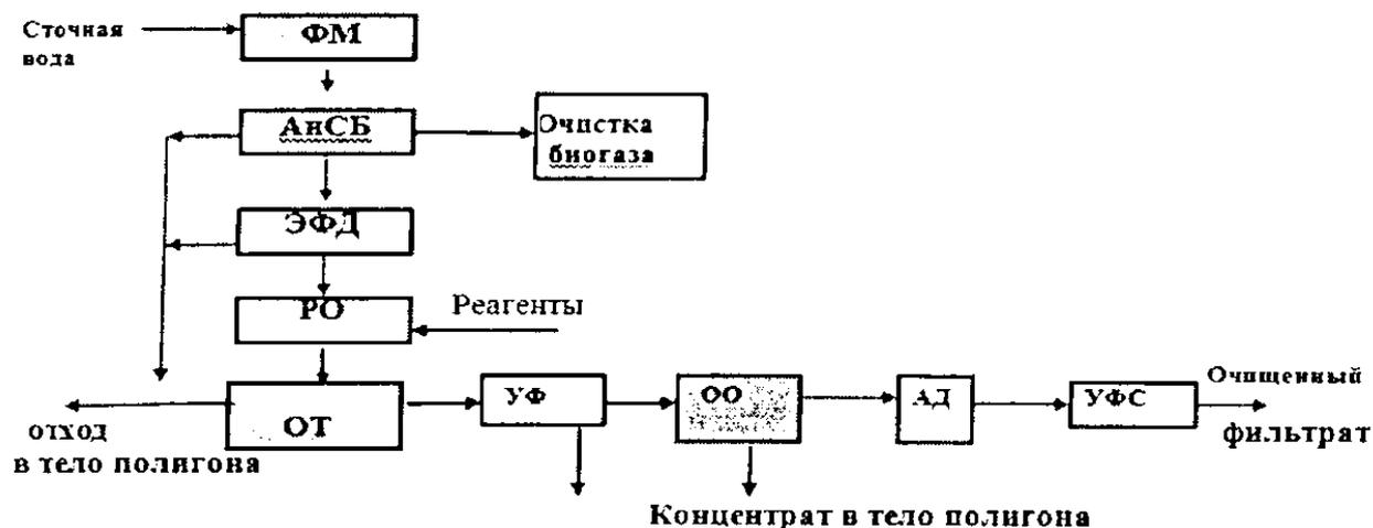
ФМ – фильтр механический, АнСБ – анаэробное сбраживание, ЭФД – электрохимическое окисление, РО – реagentная обработка, ОТ – отстаивание, УФ – напорная ультрафильтрация с полволоконными мембранными элементами, ОО – обратная осмос, АД – доочистка сорбцией, УФС – дезинфекция ультрафиолетовым стерилизатором
