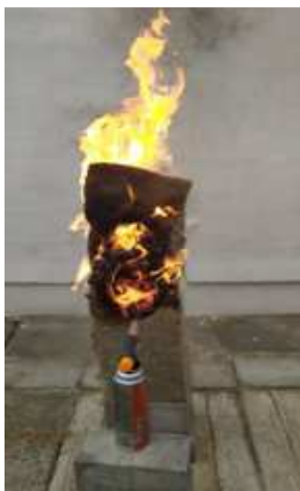
Рисунок 7. – Воздействие огня на плиту «Акотерм флакс» во время испытания
