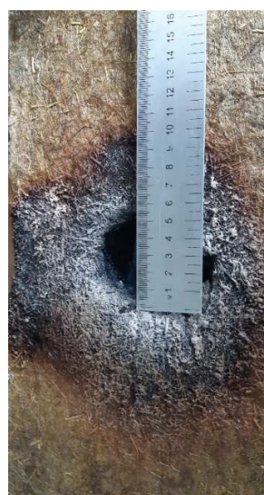
Рисунок 6. – Внешний вид плиты после воздействия открытого пламени
