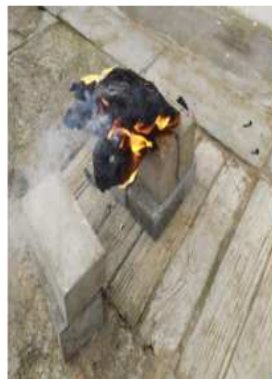
Рисунок 8. – Горение плиты после устранения открытого пламени
