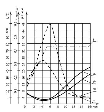
$ho_1$ ,  $\eta_1$  — соответственно удельное электросопротивление и проводимость бетона без активированной суспензии;  $ho_2$ ,  $\eta_2$  — соответственно удельное электросопротивление и проводимость бетона с активированной суспензией; t — температура прогрева бетона
