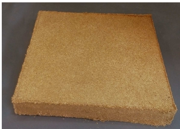
Рисунок 4. – Образец из молотой ржаной соломы для определения истинной плотности
