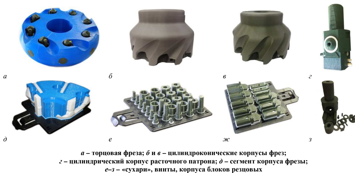
Рисунок 7. – Макеты конструкций блочно-модульных торцовых фрез, расточного патрона и основных элементов, выполненных с применением технологии трехмерной печати
