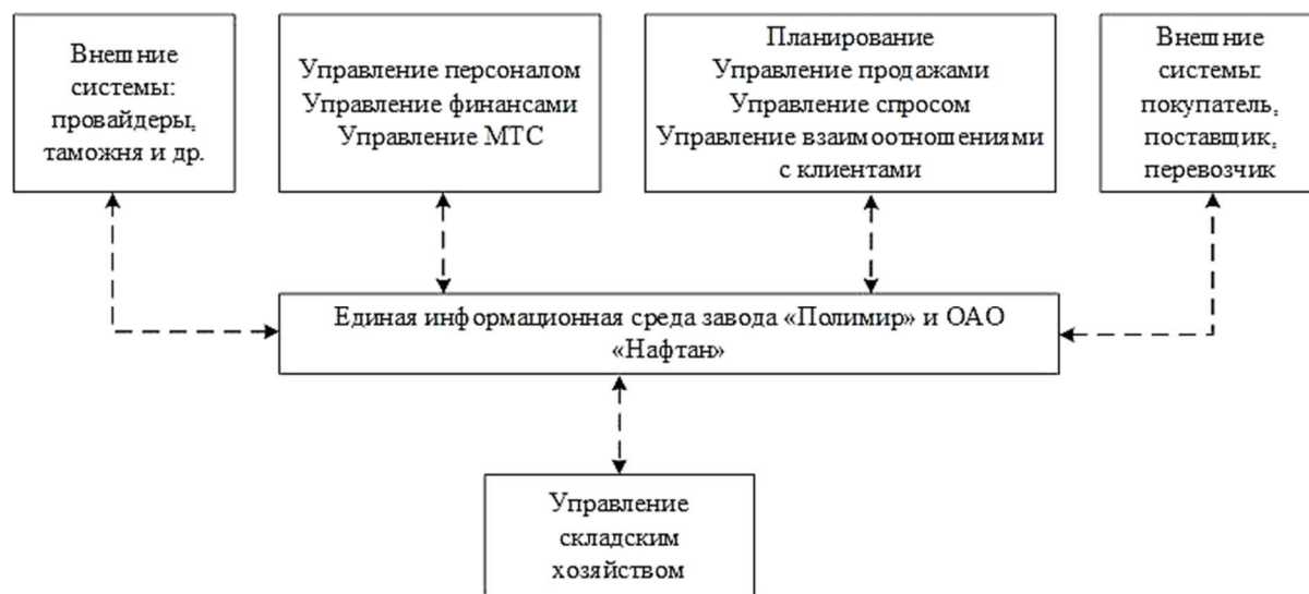
Рисунок 2. – Архитектура системы управления заводом «Полимир» и ОАО «Нафтан» на базе «1С:ERP Управление предприятием 2.0»
