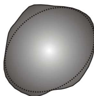
Рисунок 5. – Схема вычисления коэффициента окатанности зёрен грунта
