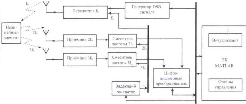
Рис. 3. Структурная схема предлагаемого нелинейного радиолокатора, использующего DSB-сигнал
