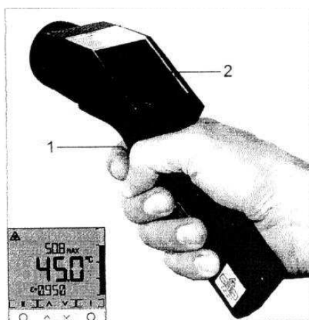
Рисунок 8.5. – Проведения измерений при горизонтальном положении пирометра
