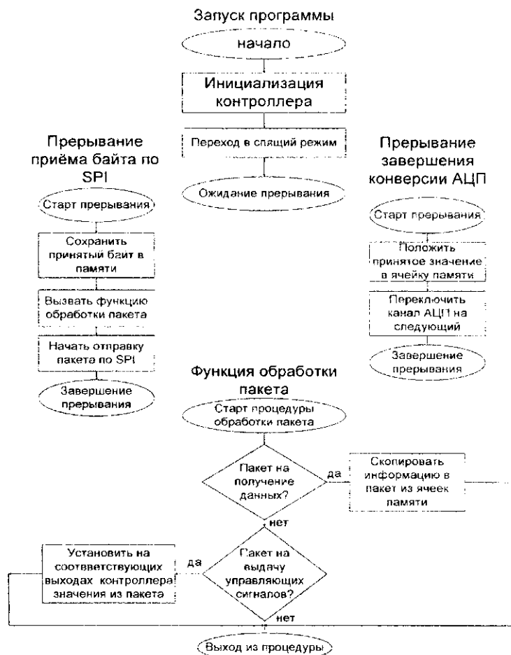
Рис. 4. Схема работы управляющего микроконтроллера
