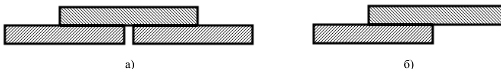
Рис. 2. Паяные соединения пластин: а – с накладкой; б – нахлесточное
