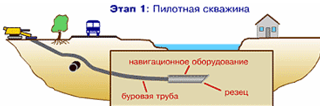
Рисунок 1.2.2. - Бурение пилотной скважины
