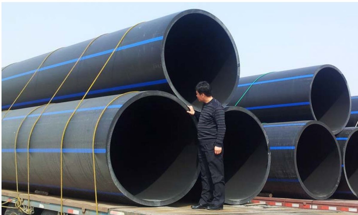
Рисунок №2.2.2. Полиэтиленовые секции труб для изготовления защитного футляра.
