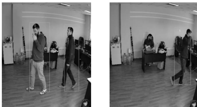
Рисунок 2. – Пример работы алгоритма для отслеживания передвижения людей внутри помещения.
