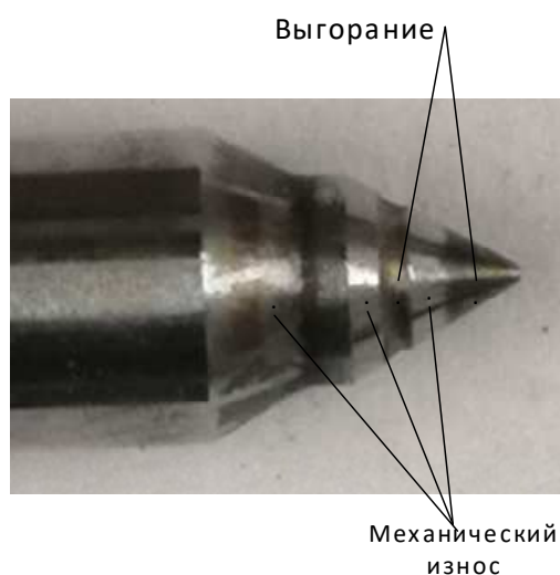
Рисунок 4. – Следы истирания и выгорания металла на игле распылителя
