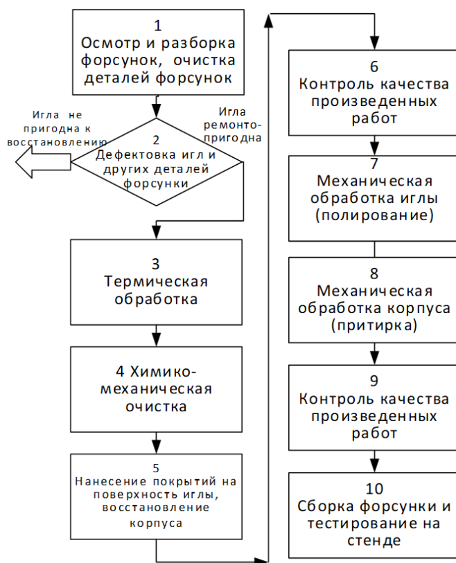
Рисунок 5. – Схема технологии ремонта форсунки дизельного двигателя
