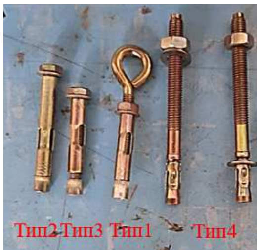
Рисунок 1. – Анкерные устройства нового типа (не стандартизированные)
