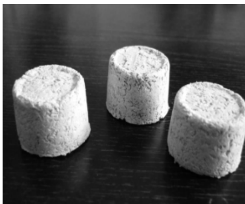
Рисунок 2. – Образцы, созданные с использованием тонкодисперсных гипсовых вяжущих
