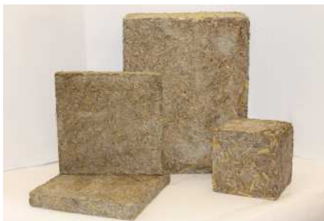
Рисунок 1. – Образцы стенового материала на основе соломы и костры
