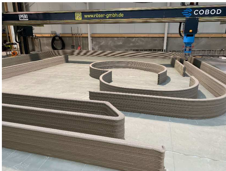
Рисунок 2. – Печать сборных конструктивных элементов в цеху
