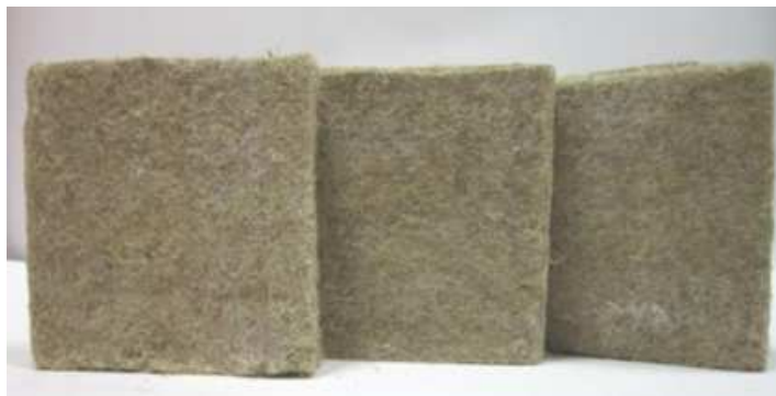
Рисунок 2. – Теплоизоляционные плиты из очесов льна
