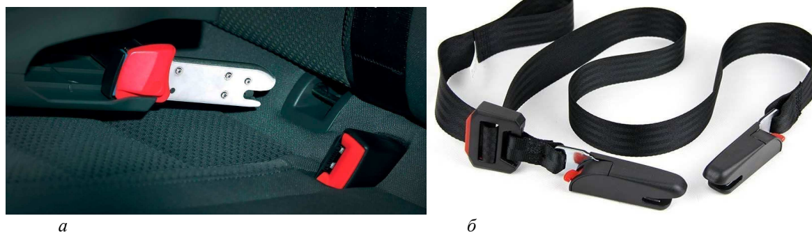
a – крепежи для автокресла в сиденьях автомобиля; б – ремень для крепления автокресла
