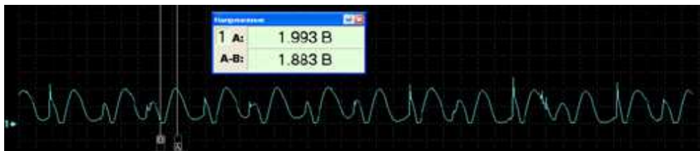
Рисунок 8. – Осциллограмма обмотки с короткозамкнутыми витками
