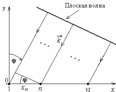
Рисунок 1. – Линейная АР в выбранной системе координат
