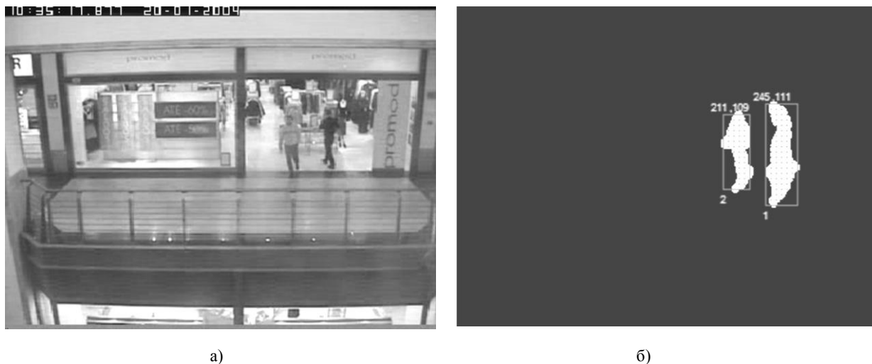
Рис. 5. Исходное изображение (а) и отсегментированное бинарное изображение с выделением объектов, определением координат их центров и описанных прямоугольников (б)
